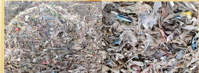
3. Nilon màng mỏng vụn và các loại rác vụn không phân hủy có nhiệt trị cao đủ tiêu chuẩn cung cấp cho các nhà máy xi măng
